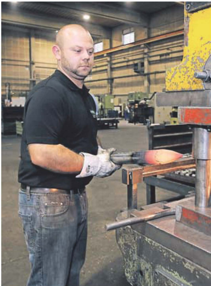
Christian Rauscher am ölhydraulischen Hammer. Per Hand führt er das Rohmaterial unter den 2000-Tonnen-Schlag.
